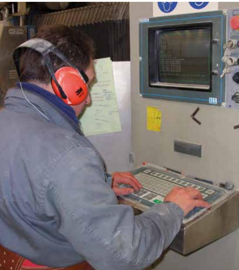
Hier wird die CNC-Maschine programmiert, die die Konturen in den Marmor fräst.
